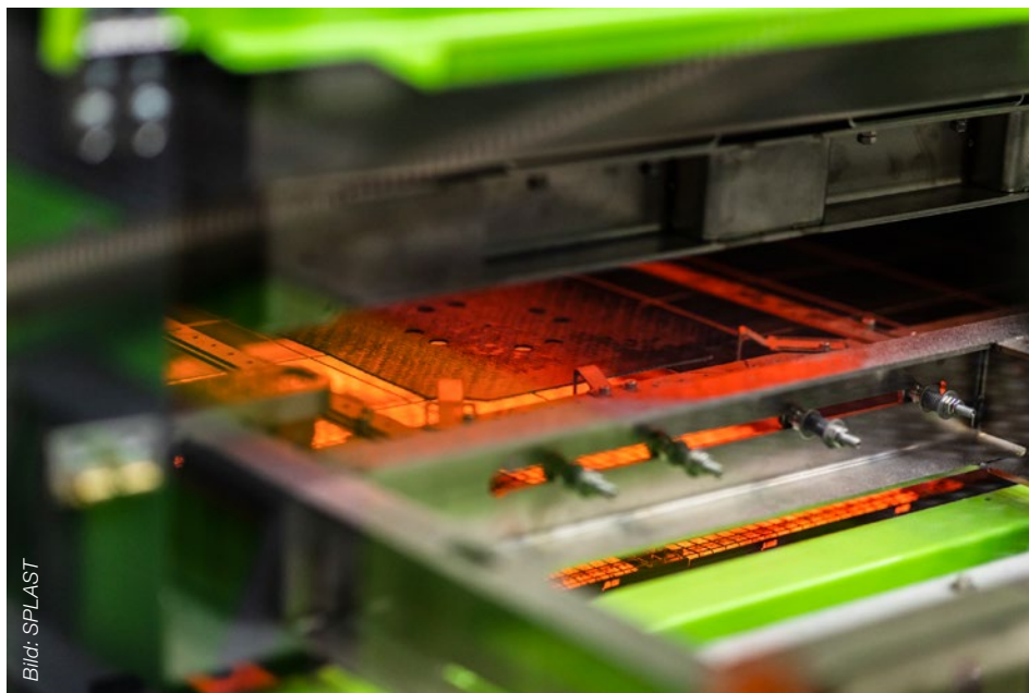
Im IR-Ofen werden die Organobleche für die organomelt-Technologie erwärmt. Er ist beweglich angeordnet und kann mit beiden duo-Spritzgießmaschinen arbeiten.
